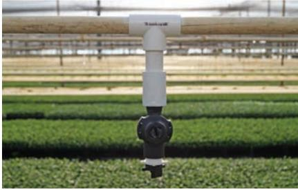
El antidrenaje Drain Stop Plus de Senninger ayuda a evitar el drenado de los aplicadores de riego invertidos. Esto mantiene el agua en las líneas de suministro, resultando en un arranque más rápido y la protección de las plantas.
