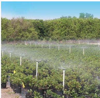
El mini-Wobbler utiliza la tecnología de acción rotativa no centrada de Senninger. Proporciona una cobertura extremadamente uniforme sobre un gran diámetro, utilizando bajas presiones.
