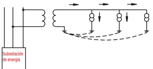
Figura 2.3 - Sistema unifilar con transformador de aislamiento.
