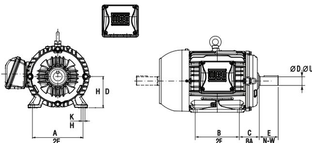
A cada altura de la punta de eje H es asociada una dimensión C, distancia del centro del orificio de las patas del lado de la punta del eje hacia el plano del apoyo de la punta de eje. A cada dimensión H, no obstante, pueden ser asociadas varias dimensiones B ( distancia entre centros de los orificios de las patas ), de forma que sea posible tener motores más "largos" o más "cortos". La dimensión A, distancia entre centros de los orificios de las
