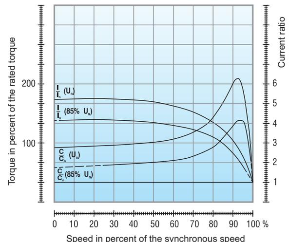
Figura 3.16 - Ejemplo de las características de desempeño de un motor de 425 cv, VI polos, cuando arranca con 85% de la tensión.
