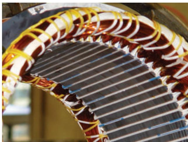
Figura 1.12a - Alambres y Films aplicados en el estator.
