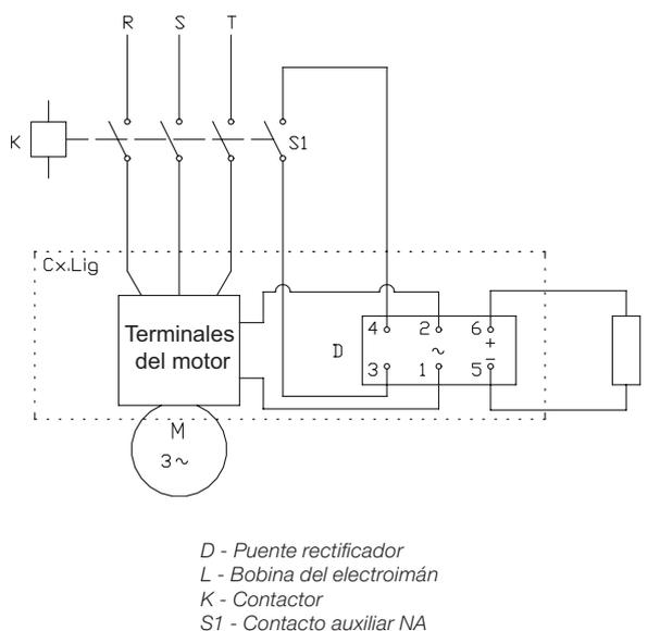
Figura 6.3 - Esquema de conexión para frenado rápido
