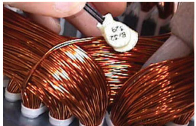
Figura 7.6 - Instalación del protector térmico bimetálico.
