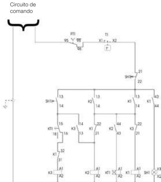
Figura 3.13 - Circuito de comando - arranque con llave compensadora.
