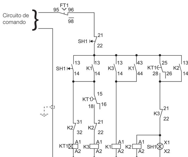
Figura 3.7 - Circuito de comando - arranque con llave estrella-triángulo.
