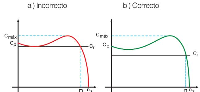
Figura 11.1 - Selección de motor considerando el conjugado resistente de la carga.
