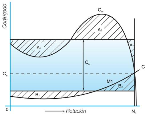
Figura 4.5 - Determinación gráfica del conjugado medio de aceleración.
