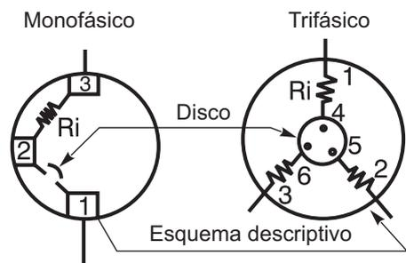
Figura 7.7 - Visualización del aspecto interno del protector térmico.
