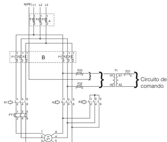
Figura 3.8 - Circuito de fuerza - arranque con llave estrella-triángulo.
